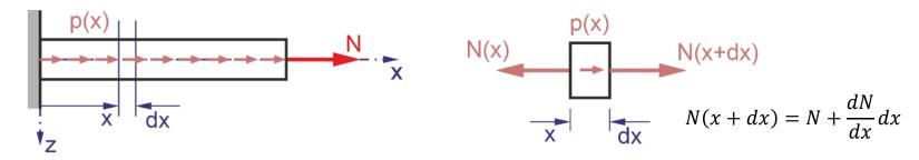
Darin ist p(x) eine in x-Richtung verteilte Last von der Dimension [N/m].
