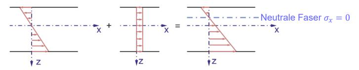
Diese Verschiebung kann so groß sein, dass die neutrale Faser aus dem Querschnitt herausgeschoben wird. Dadurch treten im gesamten Querschnitt nur noch Zugoder nur noch Druckspannungen auf, es findet also kein Vorzeichenwechsel von  $\sigma_x$  innerhalb des Querschnitts statt. Diesen Effekt macht man sich beispielsweise bei Spannbeton zu Nutze.
