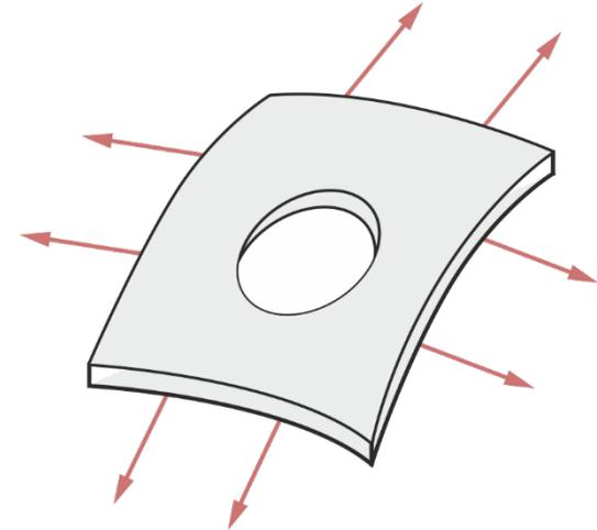
Lastfreie Bauteiloberflächen befinden sich im ebenen Spannungszustand. Dementsprechend herrscht in dünnen Blechen (siehe Skizze) ein ebener Spannungszustand.
