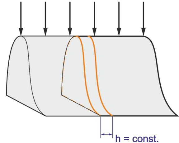
z.B. bei langen Bauteilen, die über die gesamte Länge gleich belastet sind.
