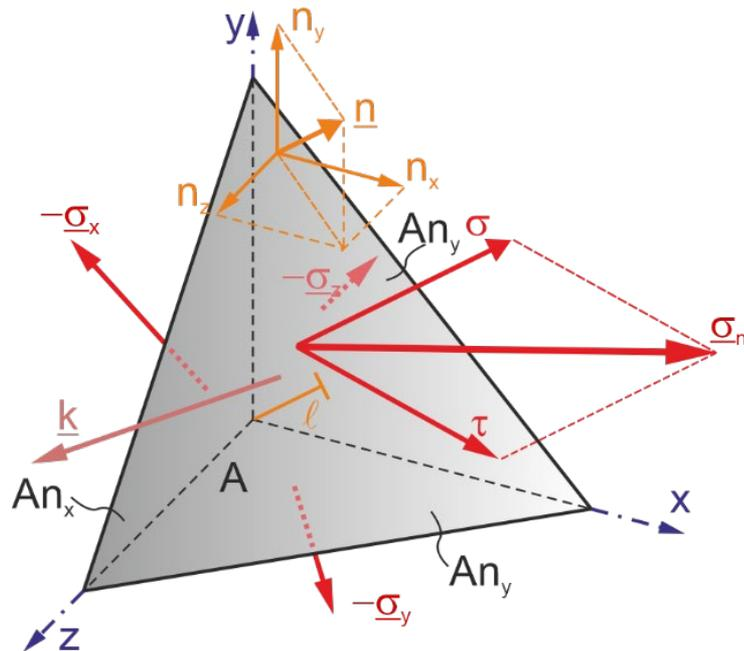
Übersichtlicher lässt sich das in 2 Dimensionen darstellen. Man erkennt, wie der  $\underline{\sigma}_n$ -Vektor in eine Normalspannungskomponente  $\sigma$  und eine Schubspannungskomponente  $\tau$  zerlegt wird:
