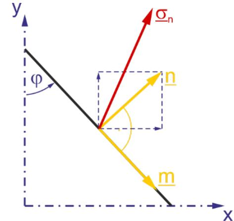
Zusammenfassend lässt sich mit folgenden Formeln ein im  $xy$ -Koord.-system dargestellter ebener Spannungszustand in ein beliebiges, dazu um einen Winkel  $\varphi$  verdrehtes  $\xi\eta$ -KS transformieren:
