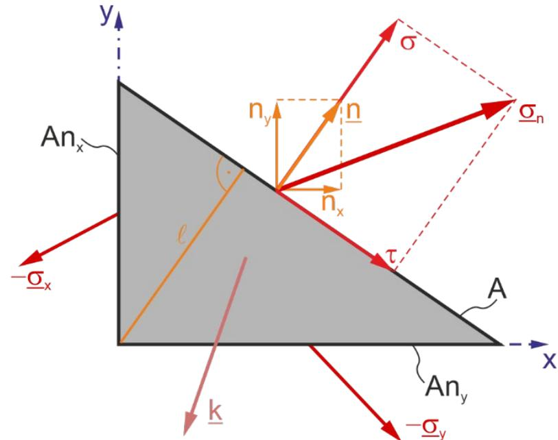
$\underline{\sigma}_n$  ist also jener Spannungsvektor, der auf die Schnittfläche mit der Normale  $\underline{n}$  wirkt.  $\underline{\sigma}_n$  ist im allgemeinen nicht normal zur Schnittfläche, sondern hat sowohl eine Komponente  $\sigma$  (**Normalspannungskomponente**) in Richtung von  $\underline{n}$  als auch eine Komponente  $\tau$  (**Schubspannungskomponente**) in der Schnittebene.
