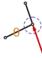
Dadurch wird ein weiterer Nullstab sichtbar. Eine Kraft wirkt in Richtung einer der Stäbe in einem Gelenk, das zwei Stäbe verbindet. → [Nullstabregel 2](#)
