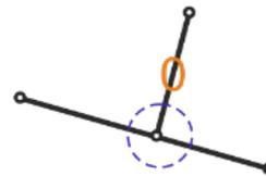
Ein Stab auf der rechten Seite mündet in ein unbelastetes Gelenk, an dem zwei gleich ausgerichtete Stäbe angreifen (T-Kreuzung). → [Nullstabregel 3](#)
