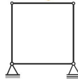
Naheliegenderweise wird man – falls möglich – zunächst einmal die Auflagerreaktionen aus dem globalen Glgw. (d.h. am Gesamtsystem) bestimmen:
