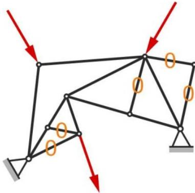
Damit überhaupt Nullstabregeln anwendbar sein, muss das Fachwerk statisch bestimmt sein. Im vorliegenden Fall gilt:
