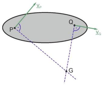
Man findet den Geschwindigkeitspol also, wenn man zwei Geschwindigkeitsvektoren an einem Starrkörper kennt, und deren Normale miteinander verschneidet.
